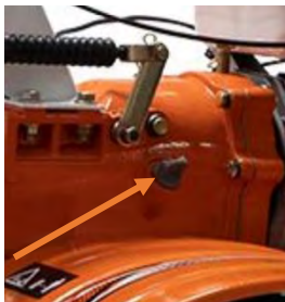
Fig. 5 – Verificarea nivelului de ulei al transmisiei
